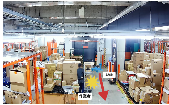
図 1: 対象環境である仮置き場。AMR がこの環境を走行中には、上に積み上げられた商品の死角によって作業者と衝突する可能性がある。また、AMR 単体では死角にいる作業者を検知するのは困難。茶色のエリアは AMR 視点での死角。
